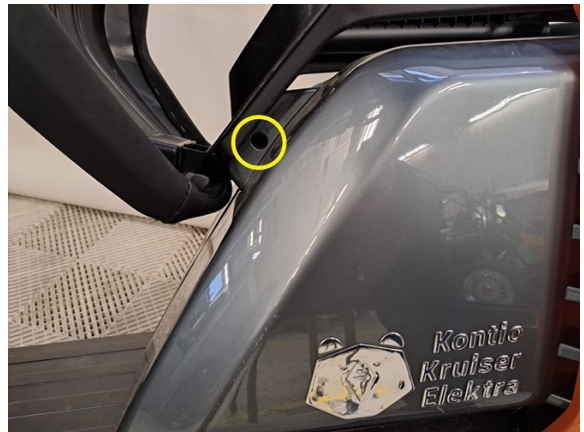
Irrota vasemman kylkipaneelin kiinnitysruuvi. (ristipäämeisseli ph2).
